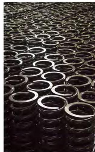
По результатам исследовательских испытаний образцы пружин производства Уральский Пружинный Завод на режимах контрольных испытаний неоднократно выдерживали 10 000 000 циклов нагружений без разрушения, что подтверждает высокое качество пружин.
